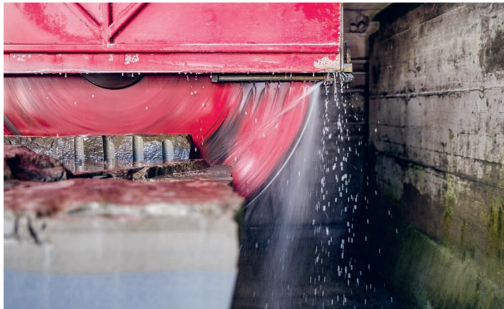
Fräsen von Werkstücken mit dem Diamantblatt.
